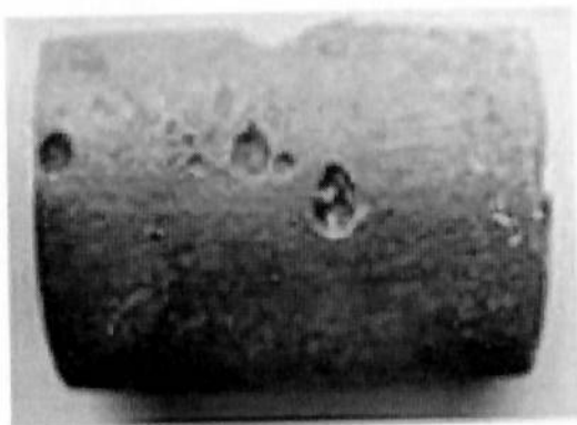
Figura 18 – Peça com corrosão alveolar 7
